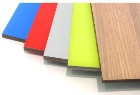
**Le HPL** est un panneau constitué de plusieurs couches de fibres papetières imprégnées de résine, pressées à haute pression et à forte température. On retrouve différentes couleurs et épaisseurs selon les parties considérées des jeux (8 et 13 mm).
