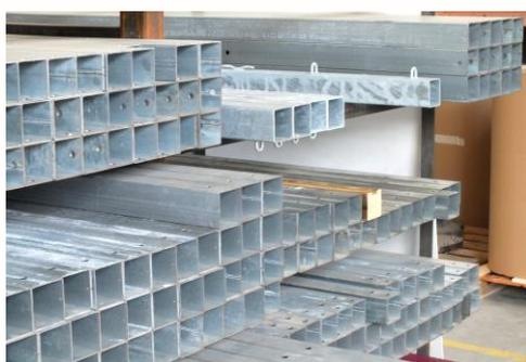
**L'acier** : les ossatures et pièces d'assemblage sont réalisées en acier, galvanisé ou inoxydable. Elles sont façonnées et assemblées par soudure. La galvanisation se fait à chaud après façonnage, par immersion dans un bain de zinc en fusion à 450°C. Leur finition peut être brute ou laquée par poudre polyester.
